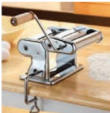
شکل ۷- دستگاه پهن کن و برش زن رشته خانگی
