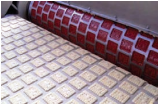
شکل ۷- قالب‌زنی بیسکویت با ماشین قالب‌زن دوار
