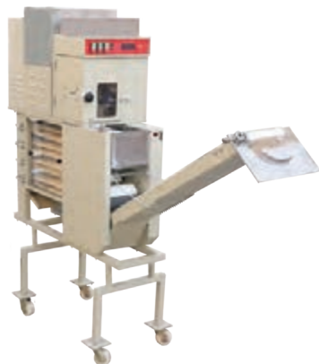
شکل ۱۰- تصاویر دستگاه چانه‌گیر
