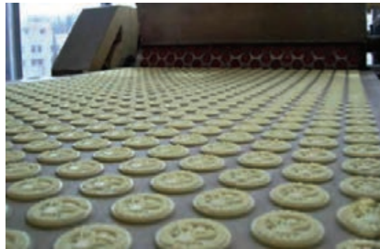
شکل ۷- قالب‌زنی بیسکویت با ماشین قالب‌زن دوار
