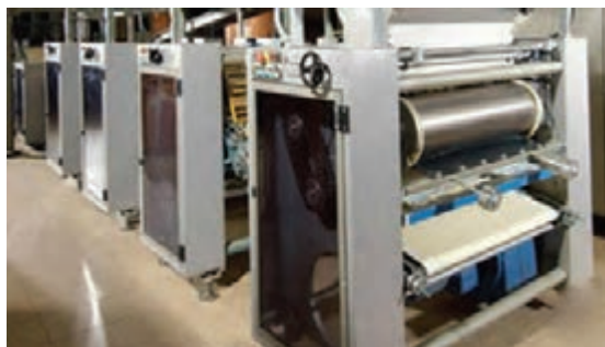
شکل ۶- دستگاه لایه‌کن خمیر
