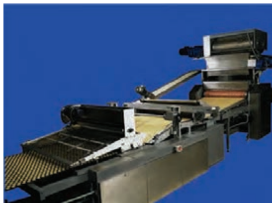
شکل ۱۳- فر تونلی پخت بیسکویت
