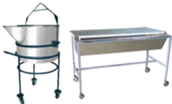
شکل ۸- تگار برای نگهداری و حمل خمیر
