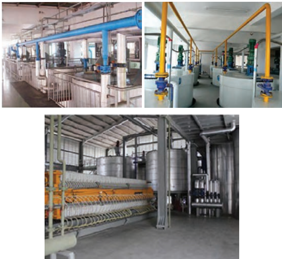
شکل ۱۰- سیستم تجهیزاتی جزء به جزء کردن روغن
